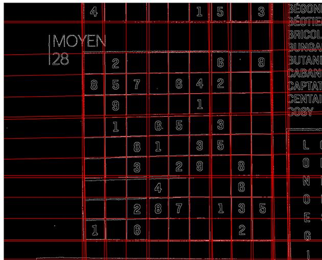
FIGURE 10 – Détection des bords via canny et détection des lignes via HoughLine
